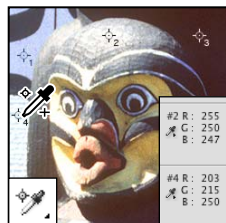
La herramienta Muestra de color muestra los valores de color de hasta cuatro áreas.
