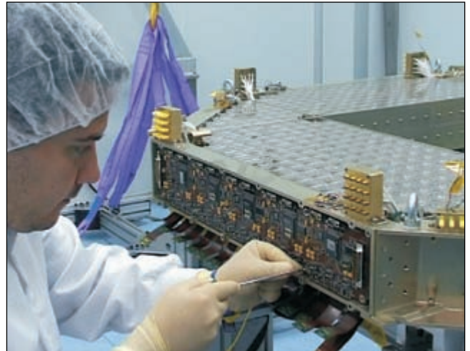
Figura 23. Integración de la electrónica de lectura del contador RICH en el CIEMAT
