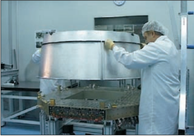
Figura 24. Integración mecánica del contador RICH en el CIEMAT
