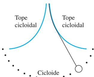
**FIGURA 11.7** En el reloj de péndulo de Huygens, la lenteja del péndulo oscila en una cicloide, de manera que la frecuencia es independiente de la amplitud.
