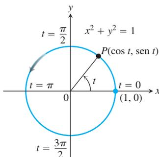
**FIGURA 11.3** Las ecuaciones  $x = \cos t$  y  $y = \sin t$  describen el movimiento sobre la circunferencia  $x^2 + y^2 = 1$ . La flecha indica la dirección en la que crece  $t$  (ejemplo 3).
