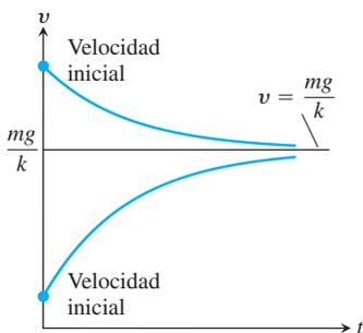
**FIGURA 9.22** Curvas típicas de velocidad para el objeto que cae y encuentra resistencia. El valor  $v = mg/k$  es la velocidad terminal.
