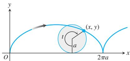
**FIGURA 11.9** La curva cicloide  $x = a(t - \text{sen } t)$ ,  $y = a(1 - \text{cos } t)$ , para  $t \geq 0$ .
