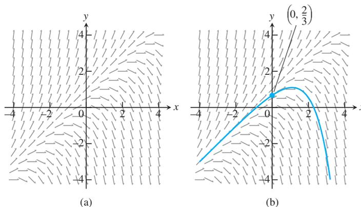
**FIGURA 9.2** (a) Campo direccional para  $\frac{dy}{dx} = y - x$ . (b) Curva solución particular que pasa por el punto  $\left(0, \frac{2}{3}\right)$  (ejemplo 2).
