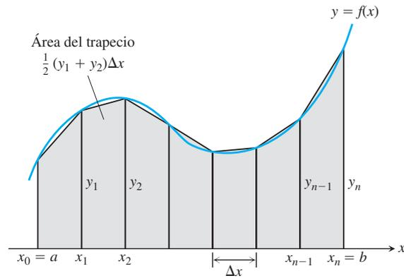
**FIGURA 8.7** La regla del trapecio aproxima pequeñas secciones de la curva  $y = f(x)$  con segmentos de rectas. Para aproximar la integral de  $f$  desde  $a$  hasta  $b$ , sumamos las áreas de los trapecios formados al unir los extremos de los segmentos con el eje  $x$ .
