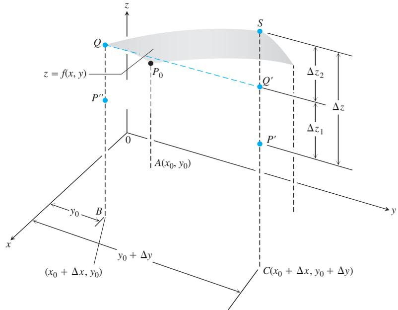
**FIGURA A.34** Parte de la superficie  $z = f(x, y)$  cerca de  $P_0(x_0, y_0, f(x_0, y_0))$ . Los puntos  $P_0, P',$  y  $P''$  tienen la misma altura  $z_0 = f(x_0, y_0)$  por arriba del plano  $xy$ . El cambio en  $z$  es  $\Delta z = P'S$ . El cambio
