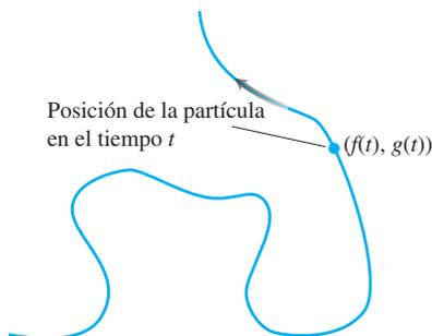
**FIGURA 11.1** La curva o trayectoria trazada por una partícula que se mueve en el plano  $xy$  no siempre es la gráfica de una función o de una ecuación.
