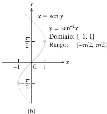
**FIGURA 7.16** Las gráficas de (a)  $y = \text{sen } x$ ,  $-\pi/2 \leq x \leq \pi/2$  y (b) su inversa,  $y = \text{sen}^{-1} x$ . La gráfica de  $\text{sen}^{-1} x$ , que se obtuvo por medio de una reflexión con respecto a la recta  $y = x$ , es una parte de la curva  $x = \text{sen } y$ .
