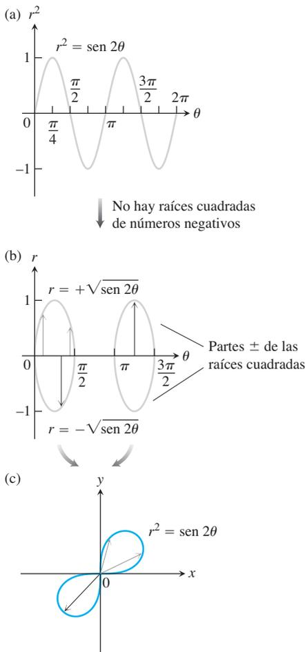
**FIGURA 11.29** Para trazar  $r = f(\theta)$  en el plano cartesiano  $r\theta$  en (b), primero trazamos  $r^2 = \text{sen } 2\theta$  en el plano  $r^2\theta$  en (a) y luego ignoramos los valores de  $\theta$  para los cuales  $\text{sen } 2\theta$  es negativo. Los radios del dibujo en (b) cubren la gráfica polar de la lemniscata en (c) dos veces (ejemplo 3).
