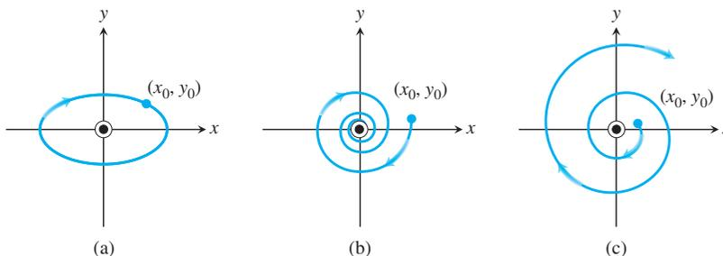
**FIGURA 9.33** Tres posibles movimientos de las trayectorias: (a) movimiento periódico, (b) movimiento hacia un punto de reposo estable y (c) movimiento cerca de un punto de reposo no estable.
