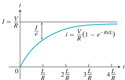
FIGURA 9.9 Crecimiento de la corriente en el circuito RL del ejemplo 4.  $I$  es el valor de estado estable de la corriente. El número  $t = L/R$  es la constante de tiempo del circuito. La corriente alcanza un nivel, dentro del 5%, de su valor de estado estable en 3 constantes de tiempo (ejercicio 27).
