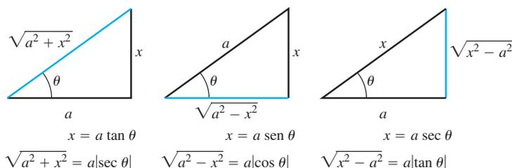
**FIGURA 8.2** Triángulos de referencia para las tres sustituciones básicas que identifican los lados etiquetados con  $x$  y  $a$  para cada sustitución.
