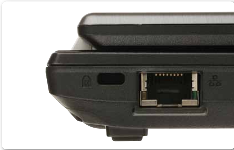
Figura 3. El puerto RJ-45 permite conectar un equipo portátil a una red de trabajo.
