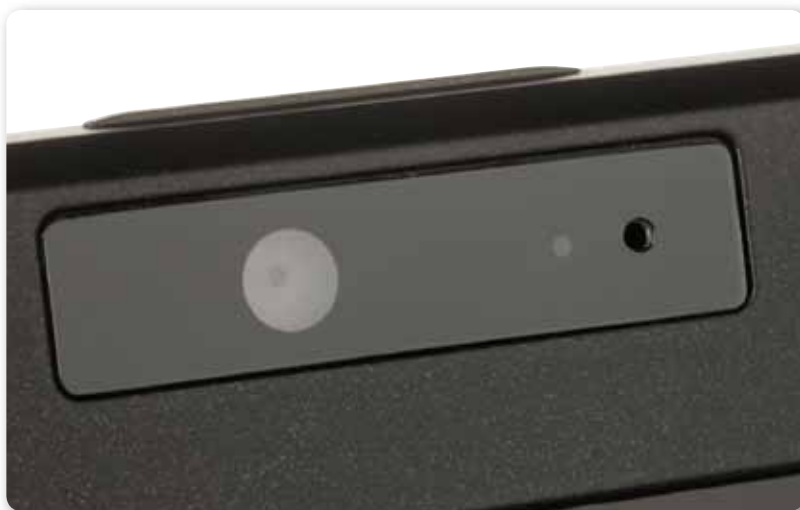
Figura 10. Actualmente, la pantalla de un equipo portátil moderno integra (de izquierda a derecha) una webcam, un LED indicador y un micrófono.
