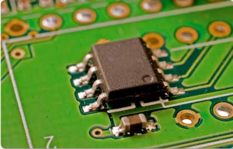
Figura 6. Los componentes SMD son sencillos de desmontar debido a que están soldados a la superficie de una PCB.
