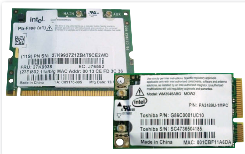
Figura 9. Las ranuras Mini PCI y Mini PCI-E son muy distintas en cuanto a su arquitectura física. La diferencia radica, generalmente, en el número y la distribución de sus contactos.
