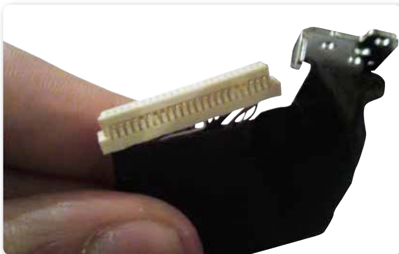
Figura 12. Los conectores LVDS se utilizan a menudo en pantallas LCD para enviar señales de baja tensión y lograr su funcionamiento.
