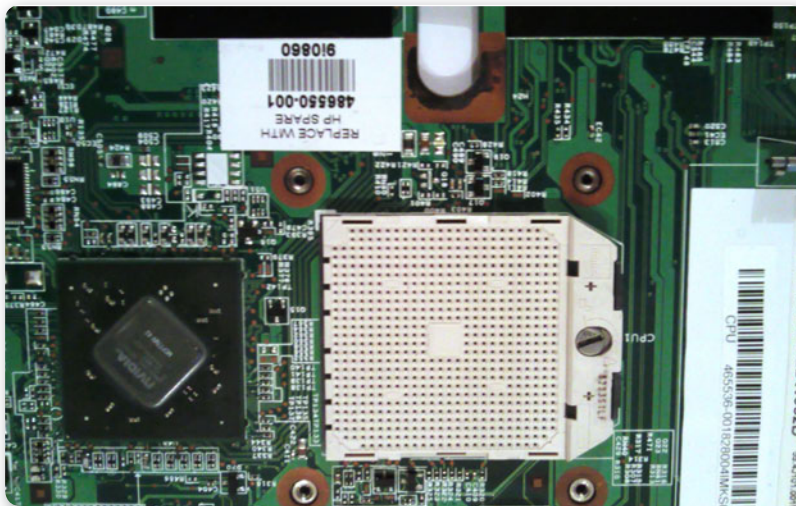
Figura 6. Los zócalos para CPU en una computadora portátil incorporan un tornillo de cierre en la parte superior, lo que permite aflojar y ajustar el microprocesador.
