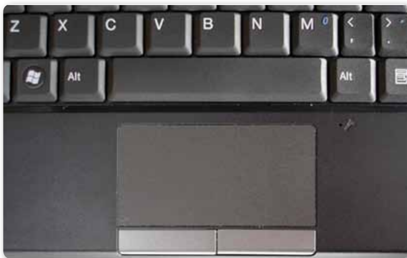
Figura 13. El touch pad y el teclado son ejemplos de periféricos externos de datos en un equipo portátil.
