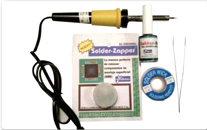
Figura 7. Herramientas como cautín , flux , pasta para desoldar (o barritas), pinzas y malla son indispensables para técnicas de montaje superficial.
