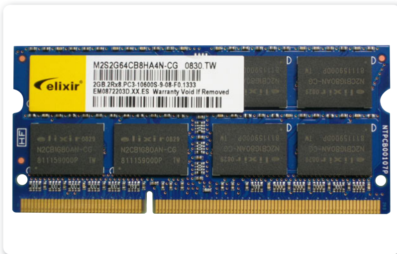
Figura 7. Los módulos SO-DIMM DDR actuales incorporan una pequeña muesca casi en el centro, lo que permite identificarlos.
