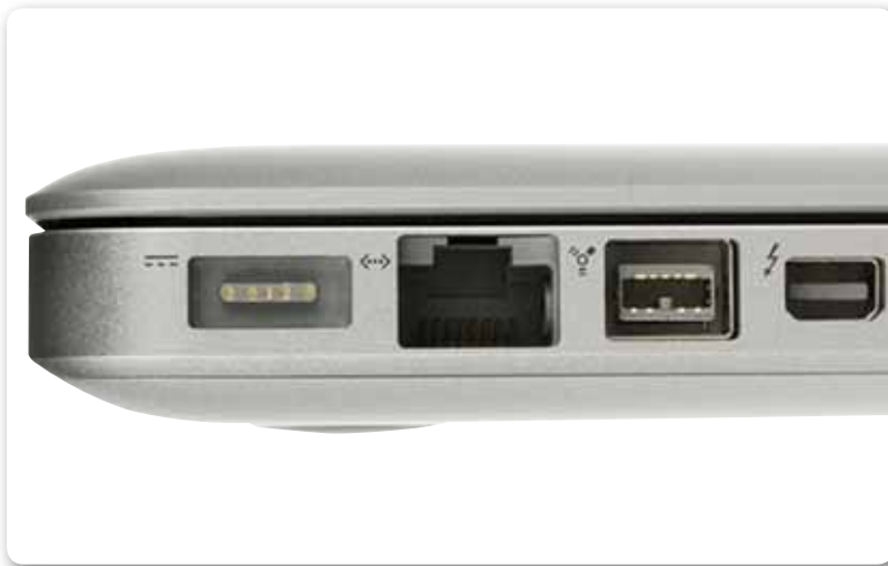
Figura 7. El puerto FireWire puede conectar hasta 63 dispositivos, y cuenta con tecnología plug & play y Hot Swappable .
