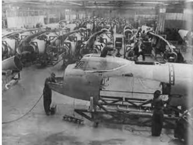
Bombarderos Mosquito en proceso de montaje en la factoría aeronáutica de De Havilland en Hatfield, condado de Hertford.
