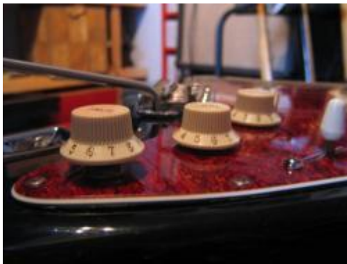
push pull para activar-desactivar coil tap
