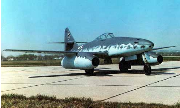
Messerschmitt 262, bimotor de propulsión a chorro. Probado a principios de 1943, pero su producción se retardo. El mejor del mundo en su época.
